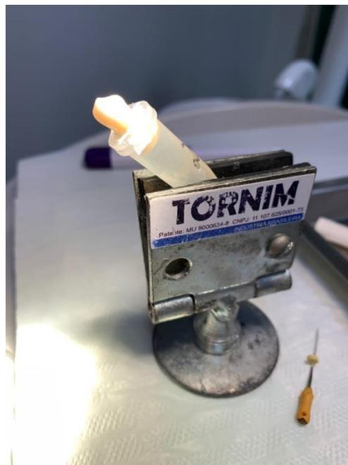
Figura 10 – Montagem do conjunto espécime/eppendorf no torno
